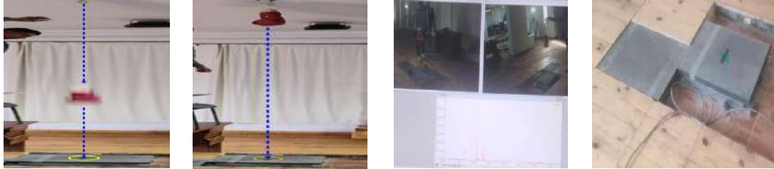
شكل (١١) منصة قياس القوة [Bertec4060-10] شكل (١٢) السقوط العمودي لاختبار القفاز
